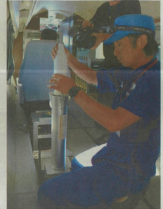
観測装置「ドロップゾンデ」を飛行機から 投下する作業(石川県輪島市沖の上空で)
